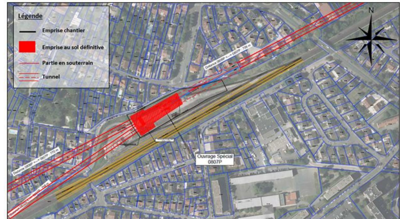
Présentation de l'ouvrage de débranchement vers le SMR au niveau de l'ouvrage annexe OA 0807P - Sentier des Marins
